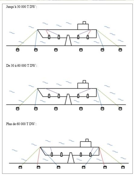
Les navires devront fournir le détail complet de leurs équipements d'amarrage et du minimum de rupture des câbles/cordes et des queues de cordes.
